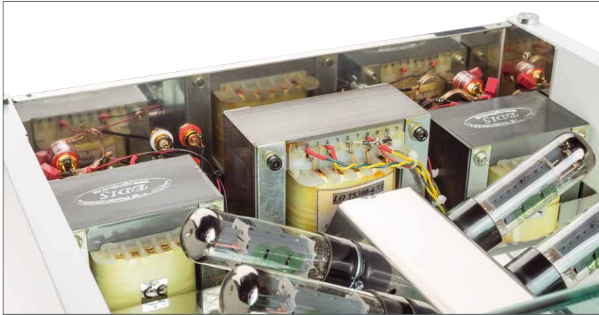
Mächtig Eisen: Leider hatten die Ausgangsübertrager nicht, was die Anmutung verspricht
